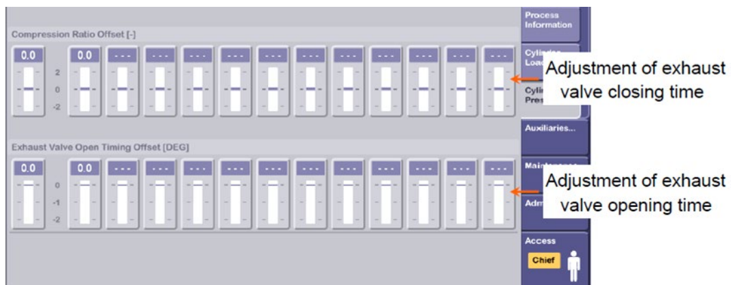
Slika 3.76. Podešavanje rada jedinice za aktuciju ispušnog ventila ME-C motora, [2]
