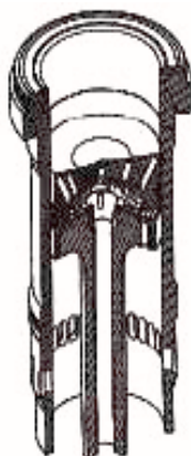
Slika 3.47. Podmazivanje košuljice na više nivoa, [5]
