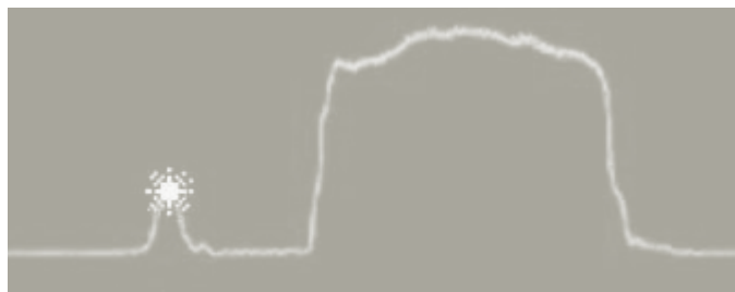
Slika 5.22. Pilot ubrizgavanje goriva
