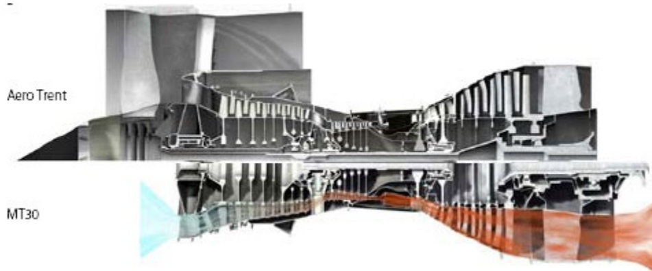
Slika 6.40. Usporedba avionske TRENT turbine i MT30 brodske plinske turbine, [15]
