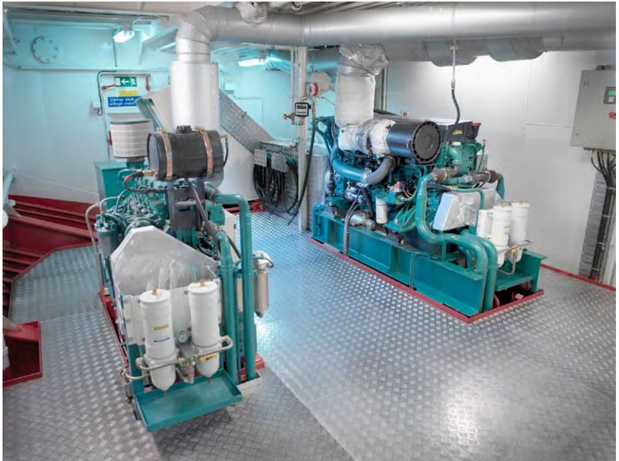
Slika 5.7. Strojarnica broda sa Volvo motorima serije TAMD 165 [5]
