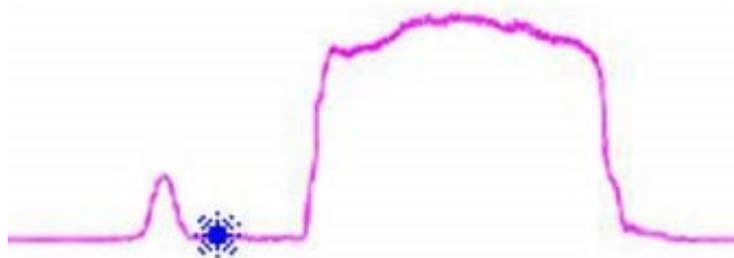
Slika 5.24. Tlak goriva u ubrizagaču
