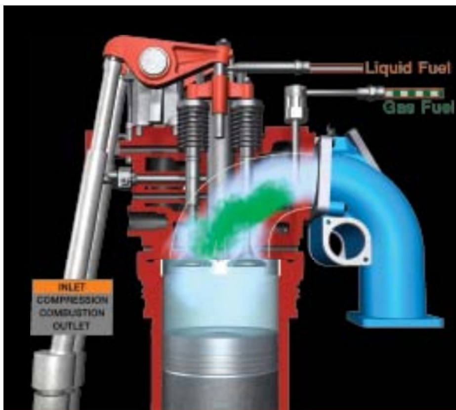
Slika 2.9. WÄRTSILÄ 50DF tehnologija sa radom motora na dvojno gorivo, [8]
