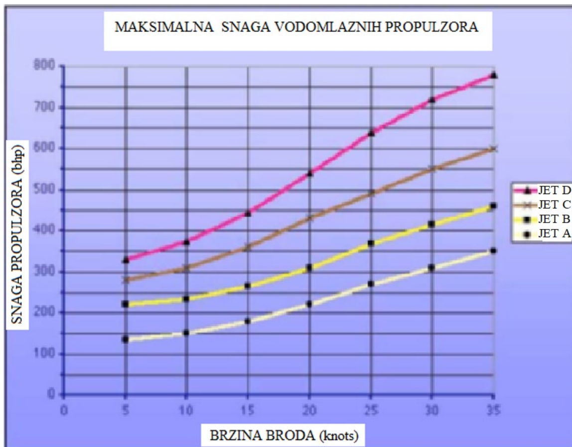
Slika 1.37. Odabir vodo-mlaznog propulzora, [23]
