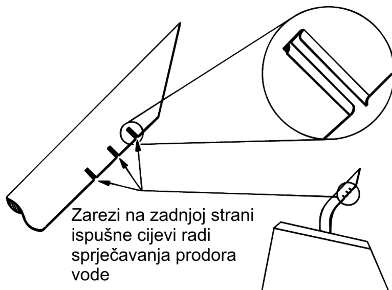
Slika 5.60. Zarezivanje kraja ispušne cijevi u opsegu od 60^\circ
