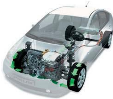
Slika 1.1. Sustav regenerativnog kočenja kod Toyota Prius
