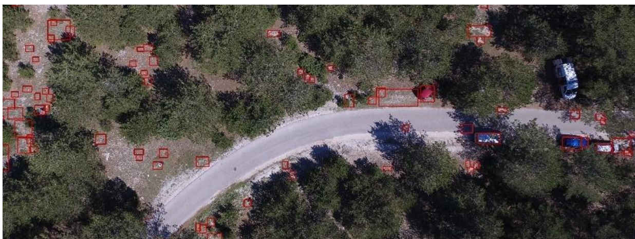
Slika 6.8. Detekcija FT algoritmom – detektirani su svi objekti sa desne strane, a sa lijeve je detektirana osoba koja se skriva u grmlju
