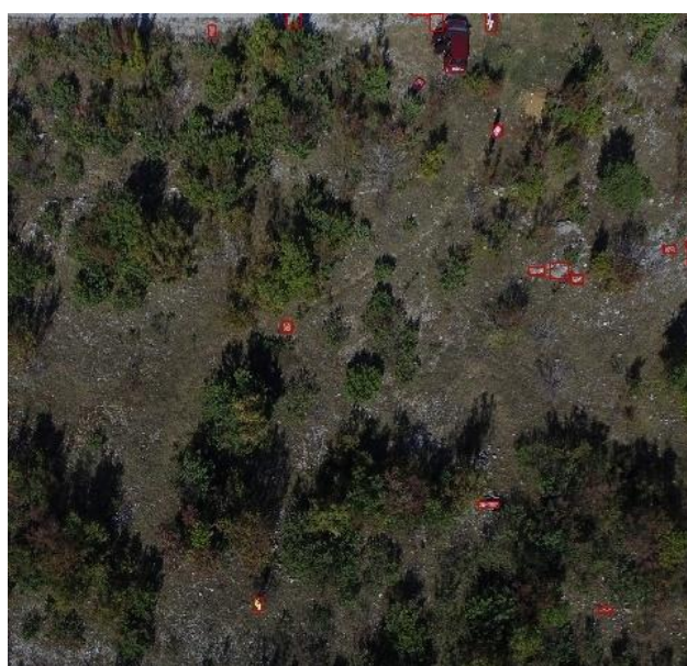
Slika 6.9b. Detekcija SW algoritmom – Detektirani svi traženi objekti uz vidljivo manje lažnih alarma
