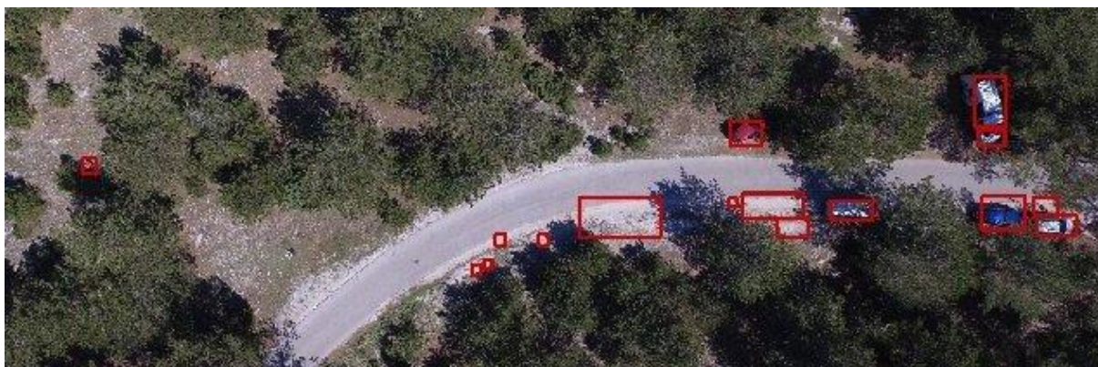
Slika 6.8b. Detekcija SW algoritmom – detektirani svi objekti uz znatno manje lažnih alarma
