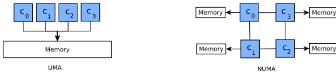
Slika 5.3. UMA (odnosno SMP) i NUMA memorijska arhitektura
