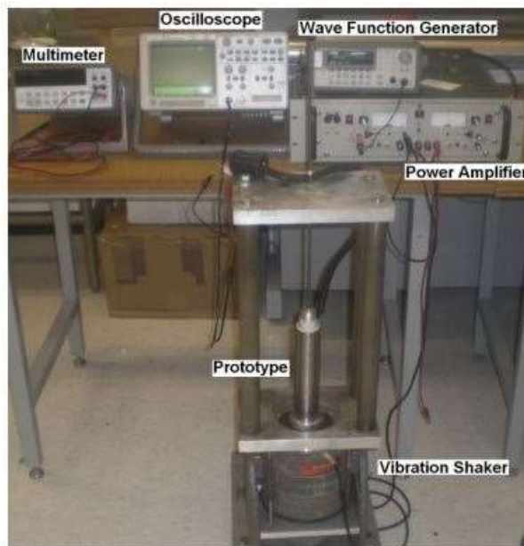
Slika 3.41. Eksperimentalna jedinica za testiranje linearnog elektromagnetskog ovjesa[86]
