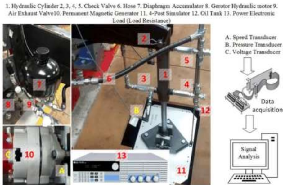
Slika 3.8. Prototip hidrauličnog regenerativnog ovjesa i njegove glavne komponente[41]
