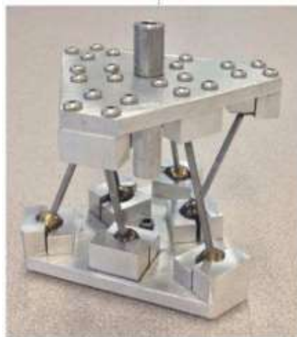
Slika 3.21. Izrađeni prototip vijčanog kinematskog para[53]
