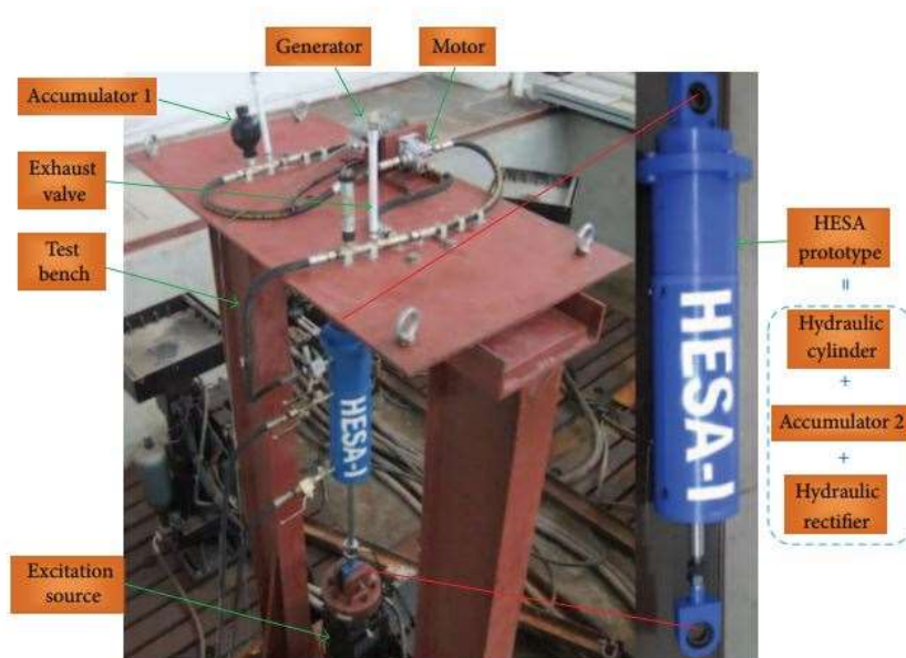
Slika 3.32. Prototip regenerativnog ovjesa i njegova ispitna jedinica[68]
