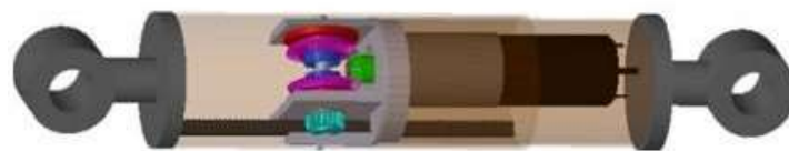
Slika 3.36. Model regenerativnog ovjesa sa montiranim ispravljačem mehaničkog gibanja[70]
