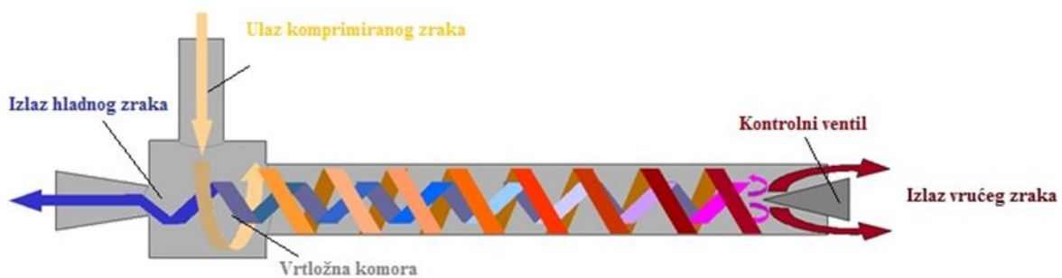
Slika 7. Ranque-Hilsch vrtložna cijev [68]
