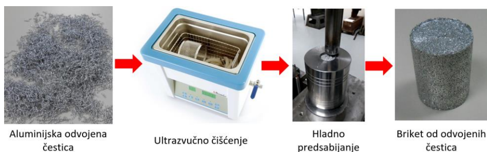
Slika 3.11. Postupak čišćenja odvojenih čestica u ultrazvučnoj kupci i faza predsabijanja u briket
