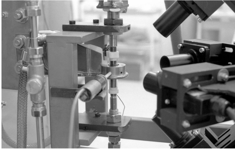
Slika 5.7. Stvarni prikaz ispitivanja toplinskog umora, [44]
