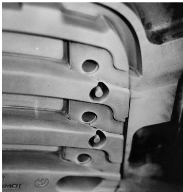
Slika 5.3. Stanje površine nepomične strane kalupa nakon nanošenja razvijača, [43]
