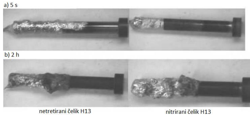
Slika 5.23. Uzorci od netretiranog čelika (a) i uzorci nitriranog čelika (b) nakon uranjanja u talinu, [40]
