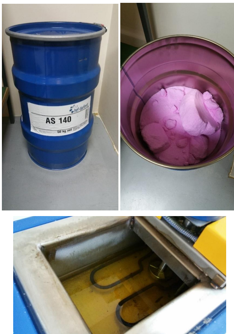
Slika 3.4. Prikaz soli AS 140 prije i za vrijeme toplinske obrade
