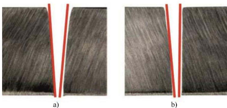
Slika 3.7. Nagib lijeve i desne strane površine reza, a) konvencionalni postupak, b) postupak rezanja s povećanim vrtloženjem plinova, [58]
