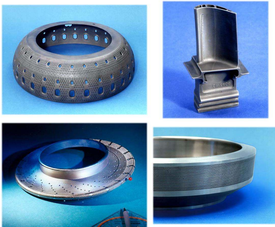
Slika 2.11. Primjeri izradaka dobivenih postupkom obrade fokusiranim elektronskim snopom, [13]
