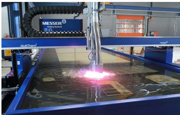
Slika 2.32. Postupak rezanja plazmenim mlazom pod vodom, [53]
