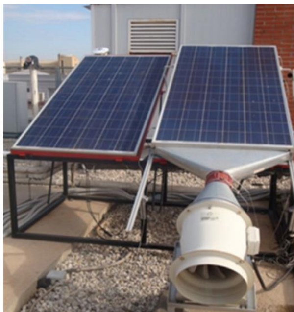
Slika 3.3. - hlađenje zrakom sa stražnje strane panela [26]
