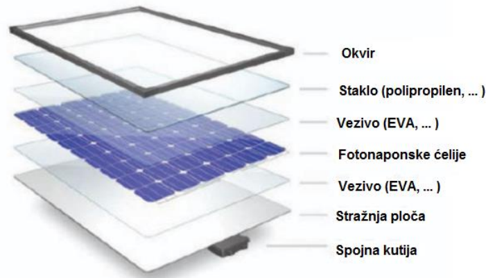
Slika 2.1. - Fotonaponski (FN) modul i njegovi dijelovi [7]
