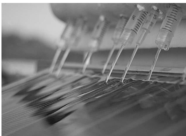
Slika 3.1. - hlađenje vodom sa prednje strane panela [9]
