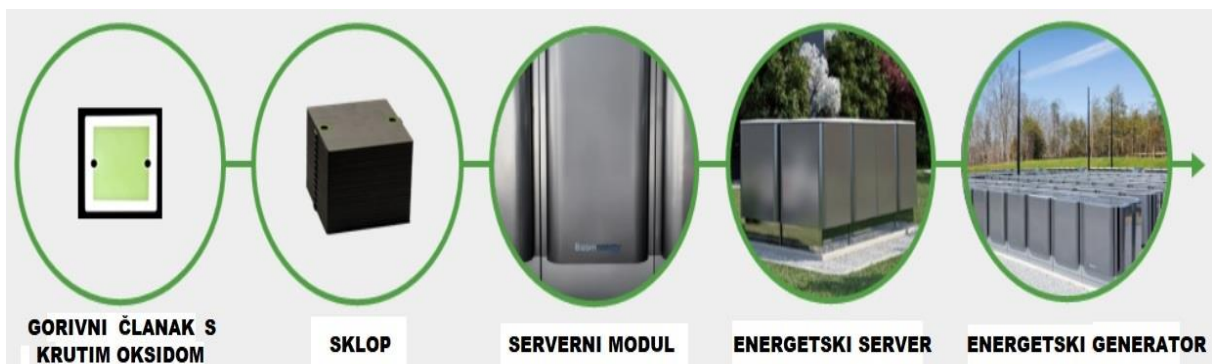
Slika 26. Povezivanje gorivnih članaka s krutim oksidom u energijski generator za proizvodnju električne i toplinske energije [113]
