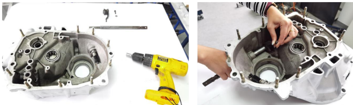
Slika 5.9 Primjer rasporeda ugradbenih dijelova na radnoj stanici prilikom određivanja idealnog vremena montaže proizvoda za element rada 1 i dio montaže
