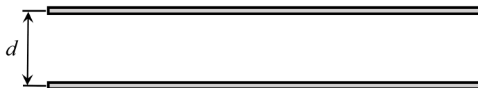
Slika 21.6. Zračni dvožični elektroenergetski prijenosni vod
