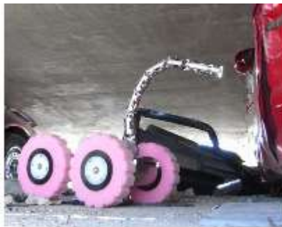
Slika 3.4 Prototip mobilnog robota sa HDOF robotskom rukom
