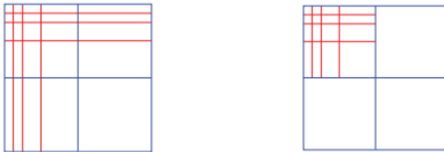
(a) Globalno 'širenje' refinement-a zbog tenzor-produkt prirode NURBS-a (b) Lokalni refinement postignut korištenjem multipatch -a
