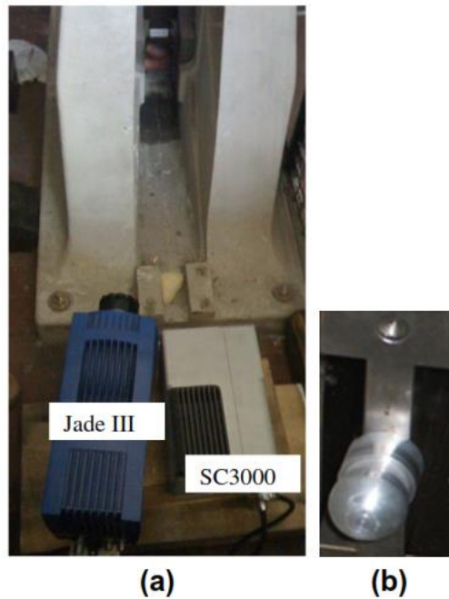
Slika 71. TSII: a) Eksperimentalni postav; b) vrh Charpyevog bata [57]
